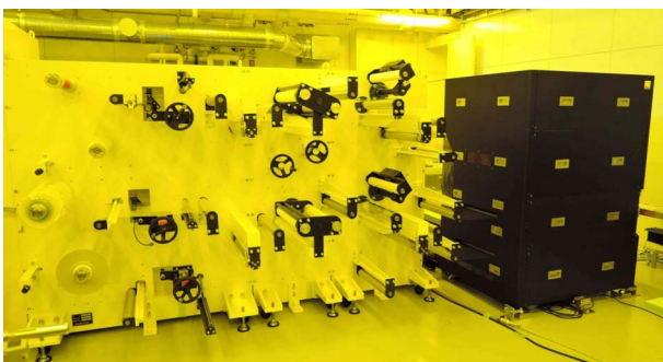
Fig. 1 開発した直描露光装置と搬送ユニットの写真
