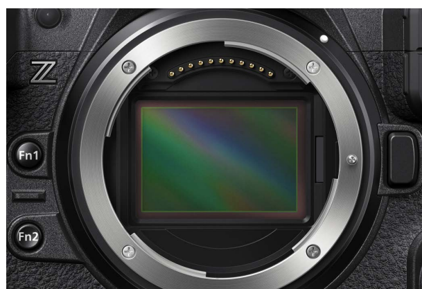
Fig. 5 積層型ニコン FX フォーマット CMOS センサー
