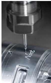
Fig. 5 Noct 彫刻文字加工
